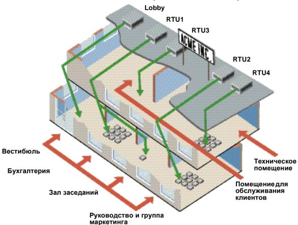
обслуживается зональным руфтопом с постоянным объемом воздуха. Техническое помещение обслуживается руфтопом VAV с шестью терминалами. Управление освещением всего второго этажа обеспечивается контроллером освещения с использованием сети Lon. В зале заседаний второго этажа регулируемый свет ламп
