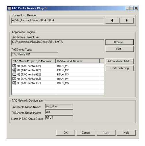
Поле **Current LNS Device** покажет Вам название выбранного устройства в сети LNS. Двумя кнопками со стрелками можно переключить на следующее или предыдущее устройство Xenta на том же канале.
