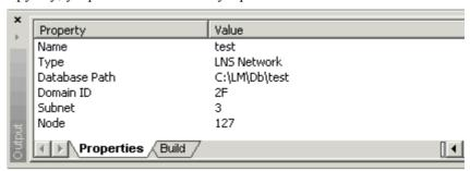
Выбор закладки Build позволяет отобразить журнал регистрации. Журнал регистрации дает информацию при создании TAC Network. Он также выдает предупреждения и сообщения об ошибках при обновлении Vista и загрузке приложения и параметров в устройство Xenta.
