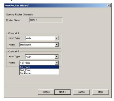
Теперь мы должны определить две стороны канала роутера RTR-1. Сторона, самая близкая к сетевому интерфейсу, всегда должна быть Channel A. В нашем случае ближняя сторона будет магистральным каналом.
