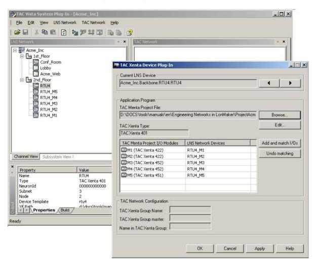
2. Нажмите **OK**, чтобы создать устройства для модулей входа/ выхода в базе данных LNS.
