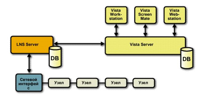
При создании баз данных Vista System Plug-in будет использоваться для пересылки сетевой информации между двумя серверными базами данных.
