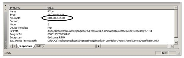
7. Установите Neuron ID для остальной части устройств в сети, следуя процессу, описанному выше.
