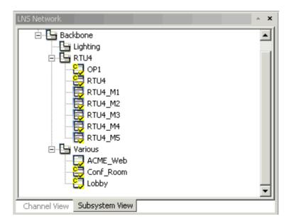
При размещении курсора на устройстве в структуре дерева Вы получите доступ к экранной подсказке, отображающей информацию о типе устройства. Вы также получите информацию об адресах подсети/узла, и введено ли в действие устройство.
