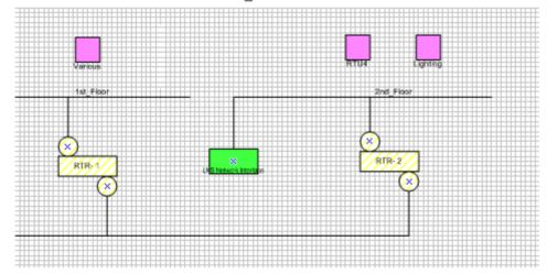
2. Физически подключите технический ПК к каналу 2nd\_Floor.
