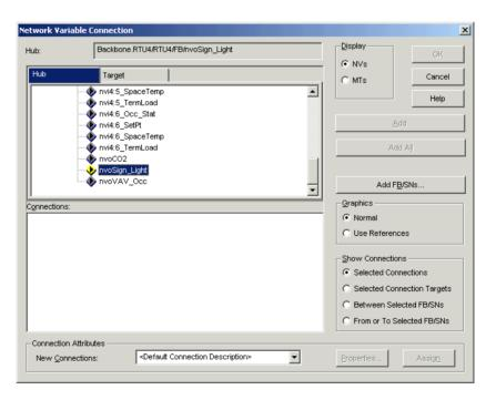
Теперь необходимо определить устройство, содержащее сетевую переменную, с которой мы свяжем SNVT Sign\_Light.
