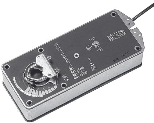
Модулирующий привод ТАС M-AF24-SR (24 V AC) с пружинно-возвратным механизмом используется для управления воздушными заслонками площадью до 3 м<sup>2</sup>, обеспечивающими функцию защиты от заморозки, дыма, пыли и т.п.
