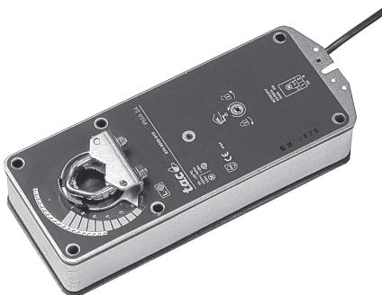
Приводы ТАС M-AF24 (-S) и ТАС M-AF230 (-S) с пружинно-возвратным механизмом (тип сигнала "открыть/закрыть") используются для управления воздушными заслонками площадью до 3 м<sup>2</sup>, обеспечивая функцию защиты от заморозки, дыма, пыли и т.п.
