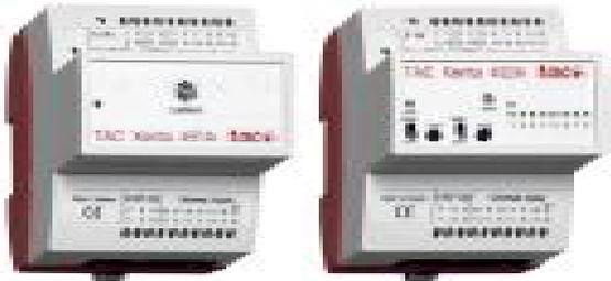
TAC Xenta 451A и 452A - блоки универсальных входов/аналоговых выходов серии TAC Xenta. Могут применяться как обычные блоки расширения TAC Xenta или сертифицированные модули для сетей LonWorks®. Оба модуля имеют по восемь универсальных входов и подва аналоговых выхода. Входы позволяют получать сигналы: цифровые, термисторные, по току или напряжению.
