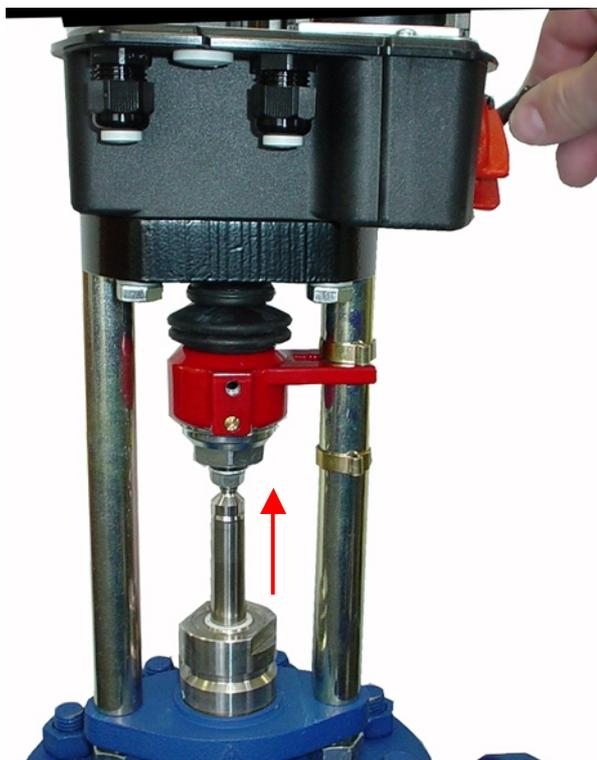
5). Вращайте регулировочный вит концевого выключателя против часовой стрелки до упора (без усилий)
