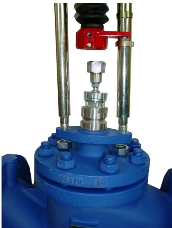
9). Наживите гайки крепления привода к клапану
