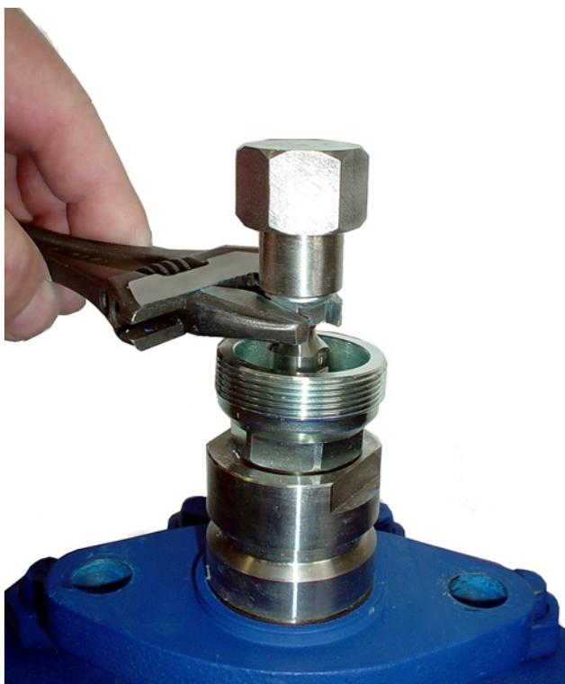
6). Перед установкой привода на клапан положите гайки под отверстия крепления привода к клапану
