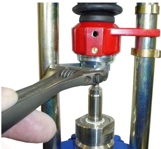
15). Затяните гайки крепления привода к клапану
