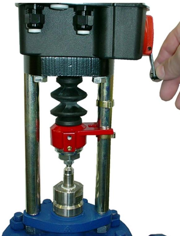
13). Подтяните (не полностью) гайки крепления привода к клапану
