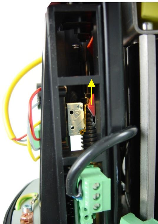
7). Вручную установите шток клапана в крайнее нижнее положение
