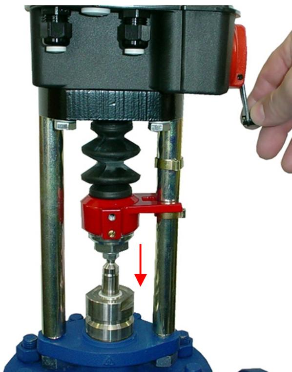
8). Отведите зубчатое колесо потенциометра от зубчатой рейки
