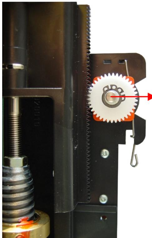
9). В отведенном состоянии проверните зубчатое колесо против часовой стрелки на полный оборот и прижмите его обратно к рейке.
