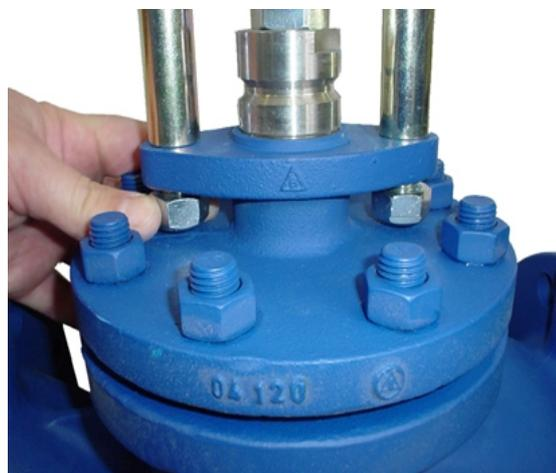
10). Вращая (не прикладывая больших усилий) маховичок привода, подведите шток привода к штоку клапана
