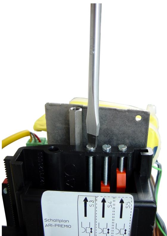
6). медленно вращая регулировочный винт по часовой стрелке, перемещайте кулачок вверх до срабатывания (щелчок) концевого выключателя.
