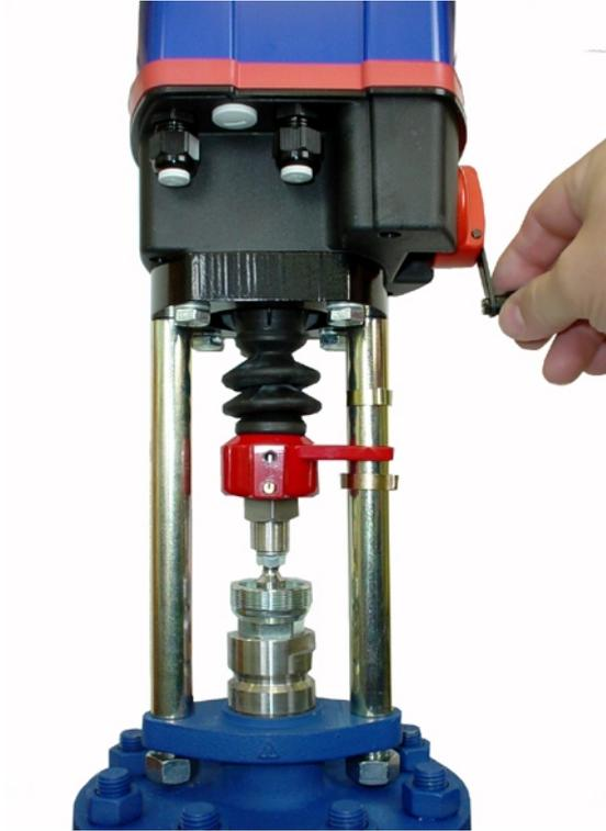
11). Соедините между собой шток привода и шток клапана с помощью накидной гайки. Гайку привинтить от руки, не затягивая
