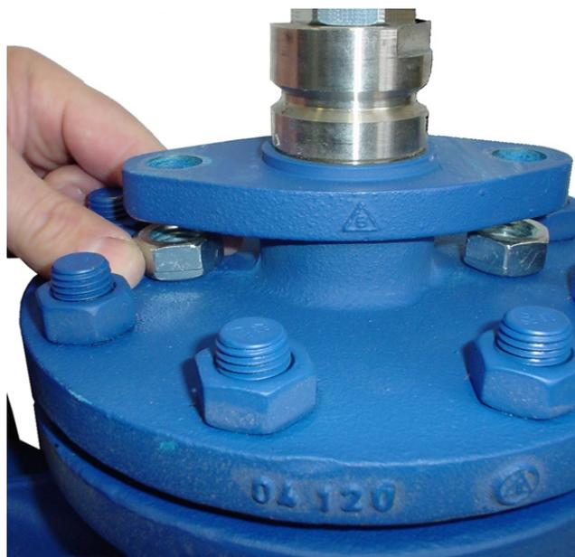
8). Вставьте направляющие привода в отверстия клапана
