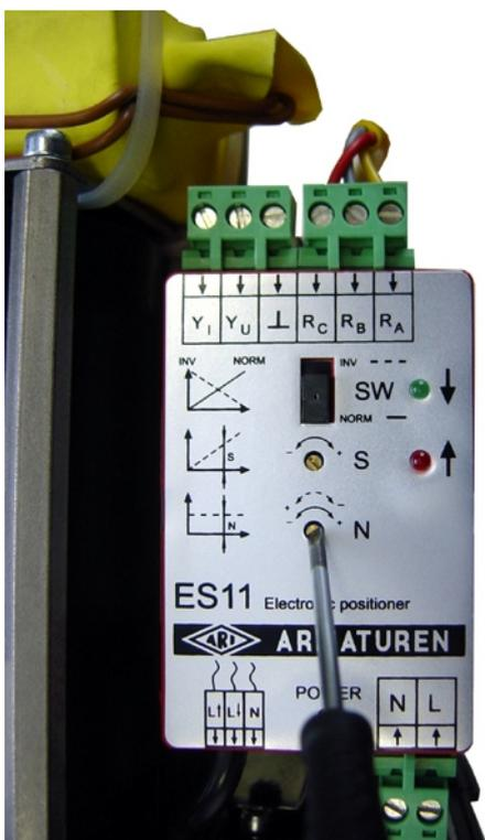
14). Подайте с контроллера управляющий сигнал, соответствующий полному открытию клапана, 10В. Вращая многооборотный потенциометр S, настройте верхнее положение штока клапана
