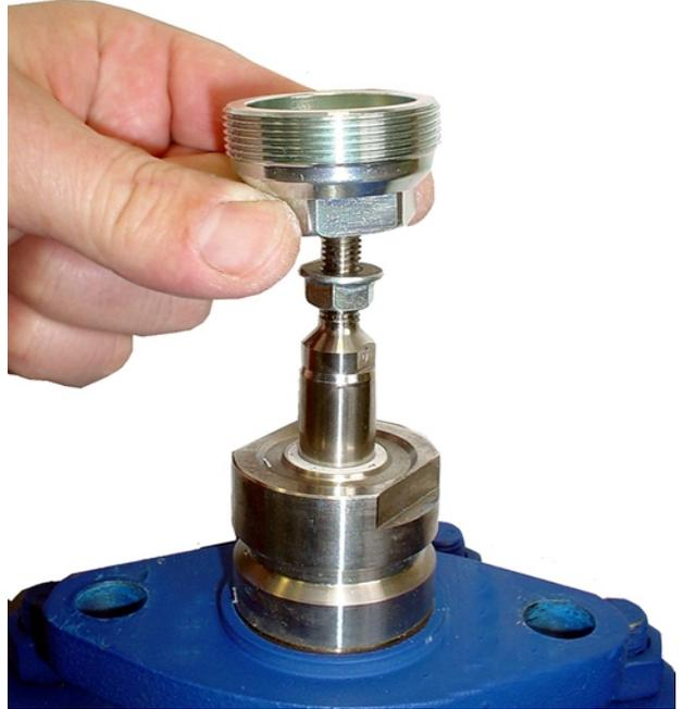
3). Выньте вторую гайку из привода
