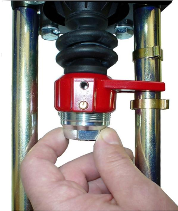
2). Наденьте гайку на шток клапана
