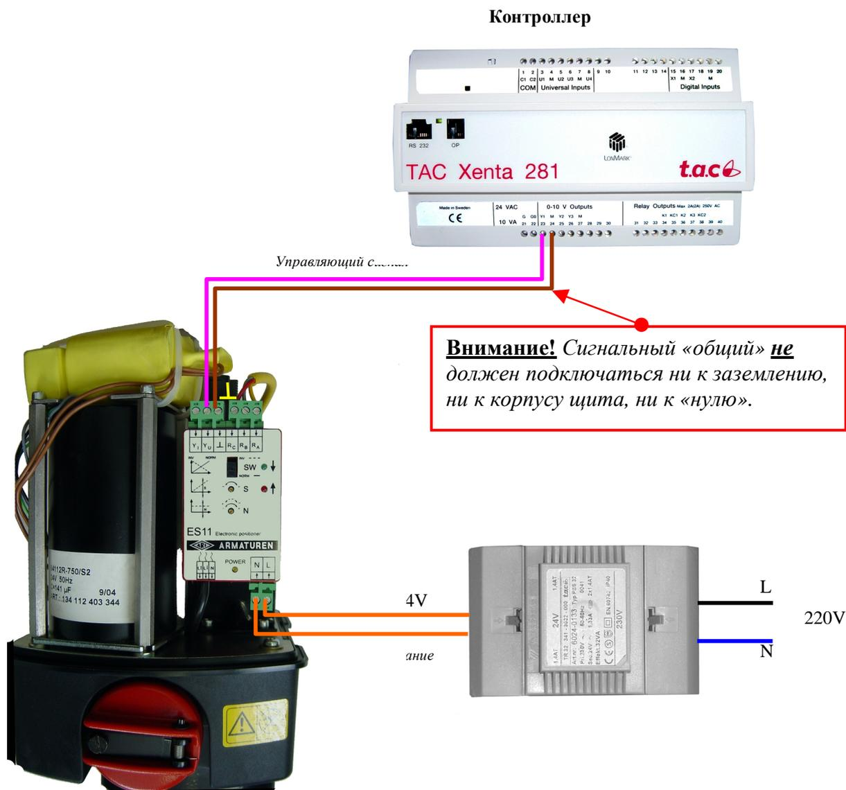
Для питания контроллера напряжением 24 вольта можно использовать тот же трансформатор что и для питания привода.
