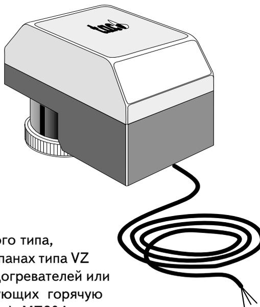
MZ20A -привод пропорционального типа, предназначен для монтажа на клапанах типа VZ (зональные) для доводчиков - подогревателей или вторичных охладителей, использующих горячую и/или холодную воду (фэн-койлы). MZ20A работает по сигналу 0-10 V.
